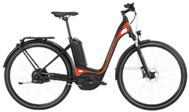
Vélo à assistance électrique Bergamont, modèle E-ville CN380 Harmony, moteur Bosch performance, batterie 500 WH, moyeu à vitesses intégrées Nu Vinci avec variation continue automatique → Velostation, Cour des Maréchaux à Mulhouse
