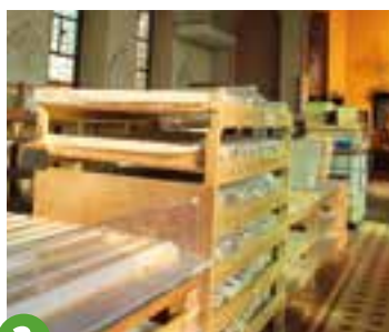
2 Le coulage dans les moules puis séchage
